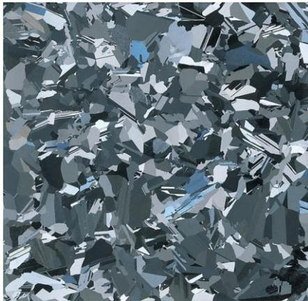
Polykristalliner Wafer für Solarzelle
